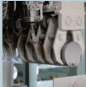
自動切断機で任意の長さにビレットを切断し、必要な本数をヒーターまで運びます。
