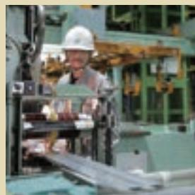
製品の形状に合わせて治具を付け替え、図面どおりの形状に矯正するのには経験と知識を備えた人の手です。
