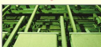
左はソーテーブルですが、スリップマーク対策のため、ローラーからベルトに変更。しかし、ベルトに変えたことにより製品に静電気が発生。そこで、除電紐を定寸ストップバーの後に取り付けて、静電気の発生を解消しました。
