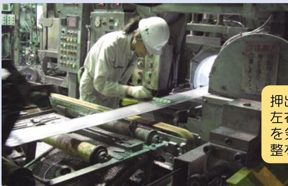
押出時の肌・形状など仕上がりを左右する、押出スピード及び条件を気候や環境変化に合わせた調整をして仕事をしています。
